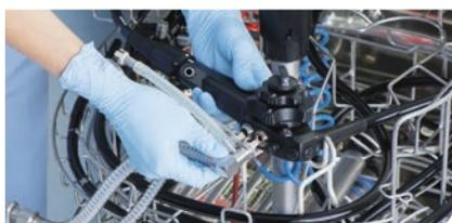
Los dos conectores del adaptador principal deben estar bien conectados al endoscopio. Asegúrese de que el adaptador principal se ajuste bien y de forma adecuada.
