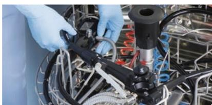
Conecte el tubo blanco al canal auxiliar de agua en la zona del conector de la fuente de luz del endoscopio.
