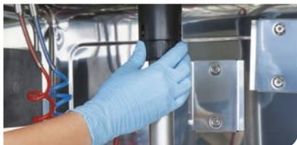
Compruebe que no haya huecos entre el conector de la cesta y el conector de la parte superior.
