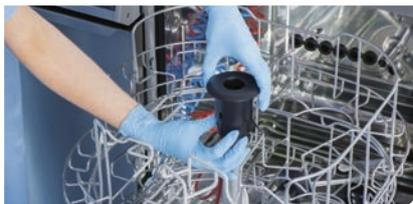
Si hay un hueco entre el disco de dirección negro y la parte superior de la cámara de lavado, ajuste la altura del disco de dirección negro hasta que encaje correctamente.
