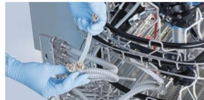
Compruebe el estado de las juntas de los adaptadores. Los soportes y las juntas deben estar en buen estado.
